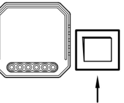
Dopo aver collegato il modulo wi-fi come da istruzioni collegamento cavi, premi l'interruttore tradizionale (collegato al modulo wi-fi) ACCESO-SPENTO-ACCESO-SPENTO per almeno 5 volte una volta al secondo oppure premi tasto reset per 10 sec fino quando la spia led all'interno del modulo lampeggia velocemente (si intravede perchè il case è parzialmente trasparente)
