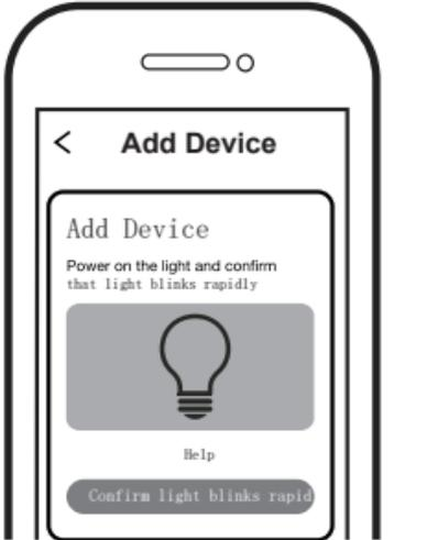
Conferma sull'app che la spia led sul modulo lampeggia velocemente. Assicurati di che la linea wi-fi a cui ti stai collegando sia 2.4 Ghz di banda di frequenza.
