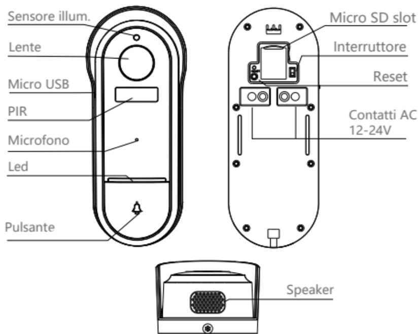
**Alimentazione** AC 12V-24V (AC supply); 18650 6700 mAh batteria al litio integrata (si ricarica con alimentatore incluso 5V 1A)
