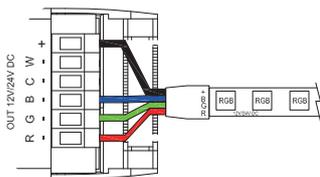
Collegamento cavi in uscita Striscia Led RGB+WW/RGB+CW
